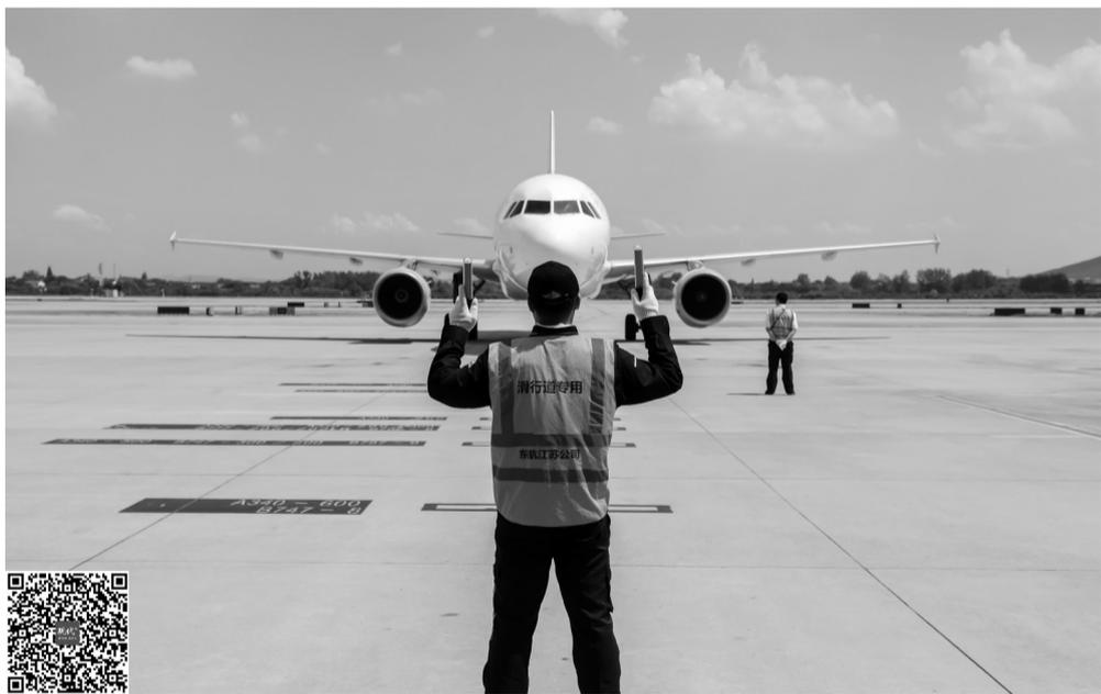
挥动手中的指挥棒,示意飞机可以减速滑行直至停下(扫码看视频)
