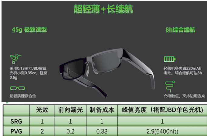
云雀技术(上)及PVG光波导技术与SRG技术AR眼镜样机技术对比情况
