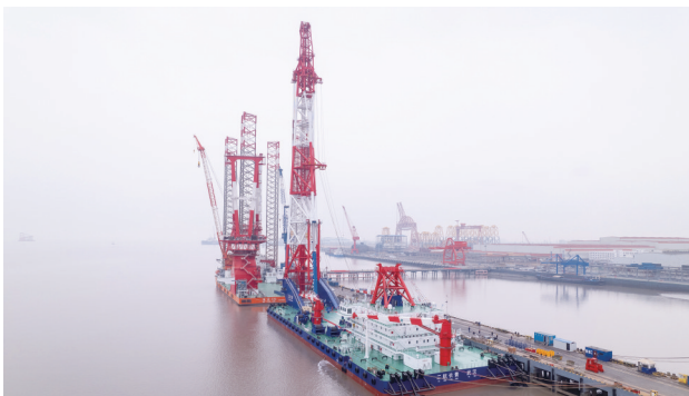
二航长青号打桩船 通讯员供图
