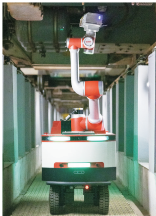
“铁宝2.0”进行巡检作业 常州地铁供图
