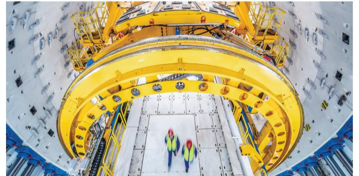
盾构机拼装机全景 图片来源:中铁十四局海太长江隧道项目
