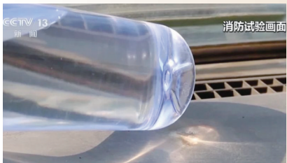
在阳光照射下,瓶装水产生凸透镜聚光效应 图源:中国消防
