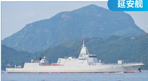
延安舰,舷号106,是我国完全自主设计建造的055型导弹驱逐舰,最大排水量超过1万吨,因此也被称为“万吨大驱”。该型舰具有隐身性强、适航性好、续航时间长、自动化水平高等特点,综合作战能力达到世界先进水平。作为一艘以我国革命圣地延安命名的“红色战舰”,延安舰始终敢为人先、攻坚克难,先后圆满完成重大演训任务20余次。
