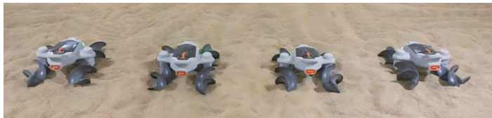
粮食储备企业智能平仓机器人 图源:南京市工信局、天创机器人、江苏省粮食集团有限责任公司、智汇麒麟
